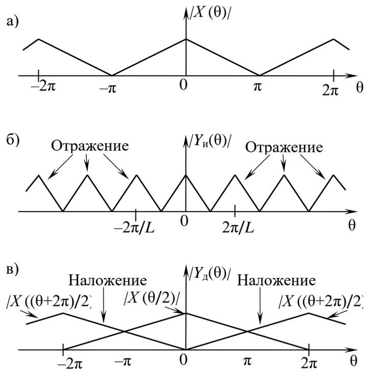
Рис. 6.2.6. Эффекты интерполяции и децимации в спектральной области:
