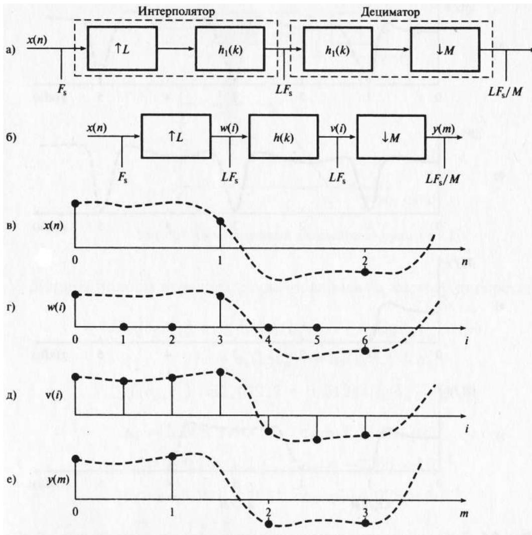
Рис. 6.3.2. Иллюстрация интерполяции с рациональным шагом ( $L=3, M=2$ )
