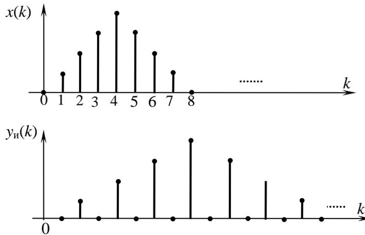
Рис. 6.2.4. Пример интерполяции при  $L = 2$
