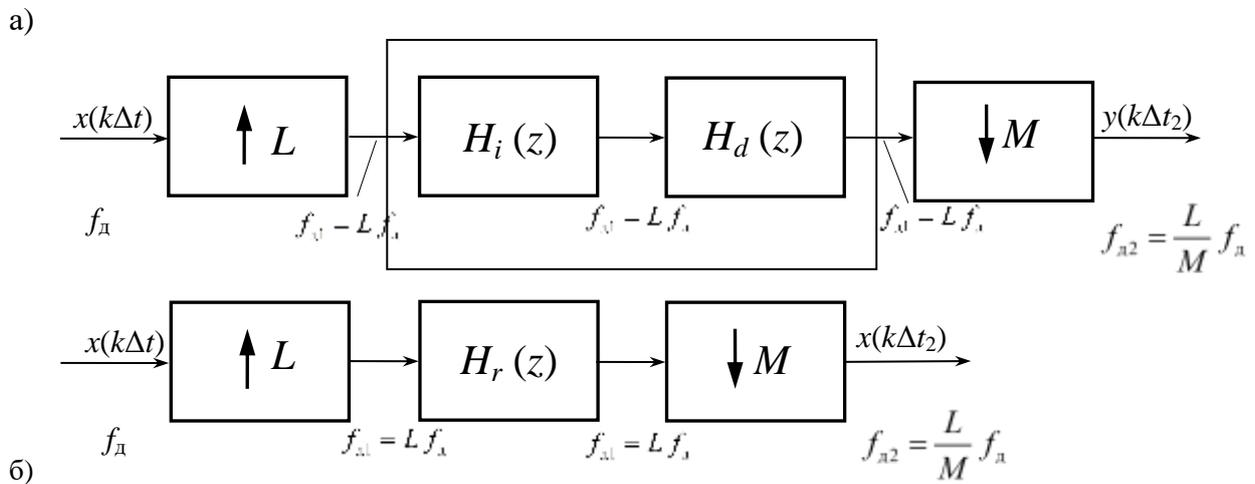
Рис. 6.3.1. Система однократной передискретизации с двумя ФНЧ (а) и одним ФНЧ (б)
