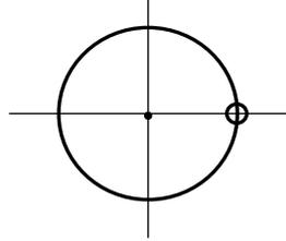
Частотная характеристика фильтра получается подстановкой в передаточную функцию значения  $z = e^{j\omega\Delta t}$
