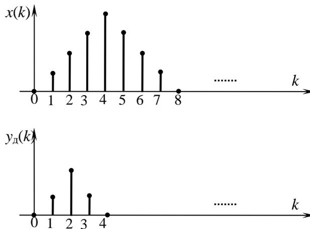
Рис. 6.2.5. Пример децимации при  $M = 2$
