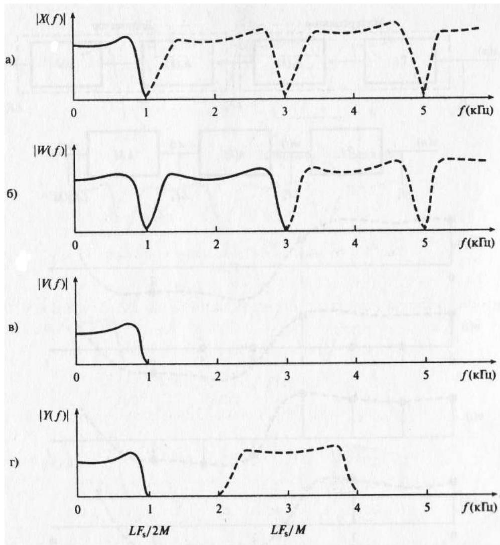
Рис. 6.3.3. Спектральная интерпретация увеличения частоты дискретизации с 2 кГц в 3/2 раза.
