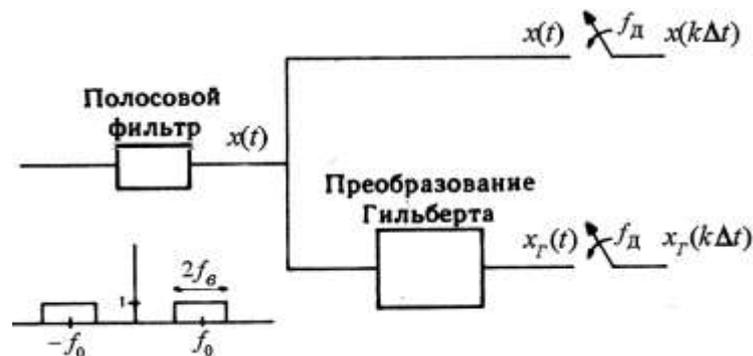
Рис. 5. Схема дискретизации аналитического сигнала
